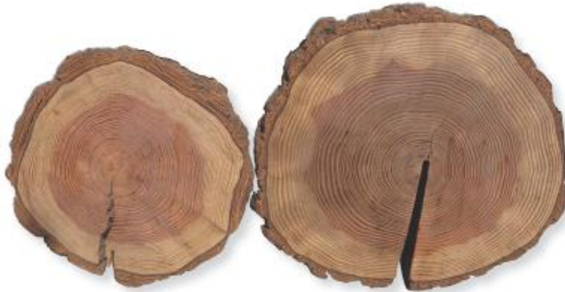
Sylviculture et largeur de cerne : deux douglas de 57 ans, l'un ayant poussé en peuplement serré à gauche (diamètre 54 cm, largeur de cernes 4,3 cm), l'autre en peuplement éclairci (diamètre 70 cm, largeur de cerne 5,7 cm) (Photo : A. Riou-Nivert).
