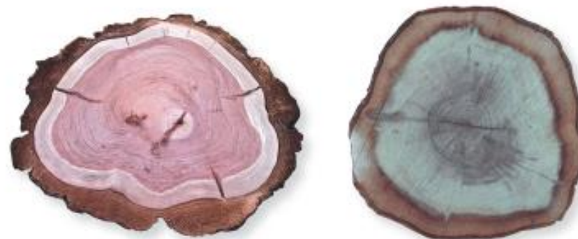
Aubier : l'aubier des résineux est de bonne qualité mécanique mais non durable (ex. du séquoia à gauche) (Photo : © Atelier des Gouges), celui des feuillus est de mauvaise qualité mécanique et non durable (ex. du chêne à droite) (Photo : Francis Barbotin - CRPF Pays de la Loire © CNPF).
